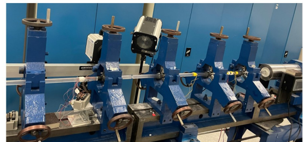
图3 聚碳酸酯杆的 SHPB 实验装置
